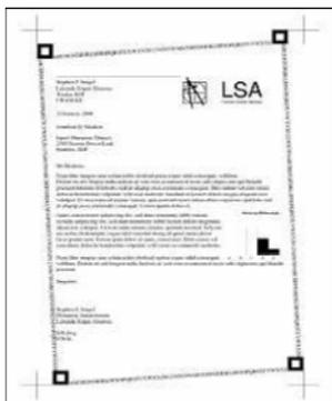
Рисунок 1 Опытный образец, используемый в стандарте **ISO/IEC19752**
