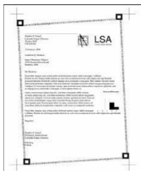
Figura 1 Model de test utilizat în ISO/IEC19752
