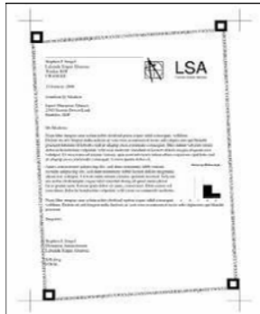
Obr. 1: Testovací vzor použitý v normě ISO/IEC19752
