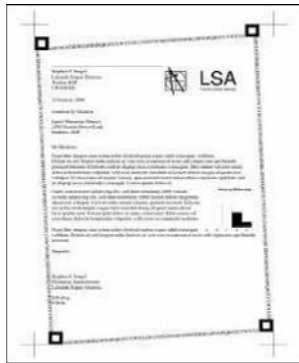
Fig. 1 Testmønster anvendt i ISO/IEC19752
