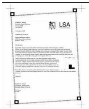
Obr. 1: Testovací vzor použitý v normě ISO/IEC19752
