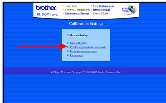
2. Haga clic en **Enviar** en la pantalla Imprimir el parche (gráficas de color) para la calibración avanzada. Se imprimirán los parches de calibración para las resoluciones de 600 ppp y CAPT.
