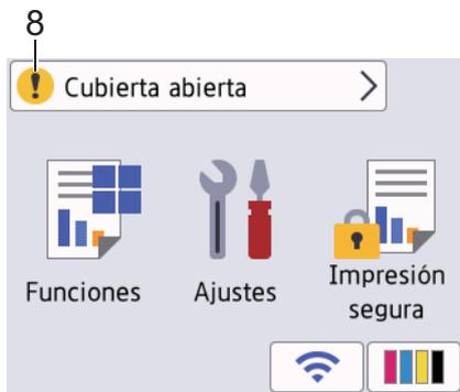
El icono de advertencia aparece cuando hay un mensaje de error o de mantenimiento; pulse para ver los detalles y, a continuación, pulse para volver a la pantalla de inicio.
