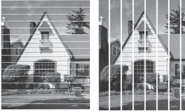
Après le nettoyage de la buse de la tête d'impression, les lignes disparaissent :
