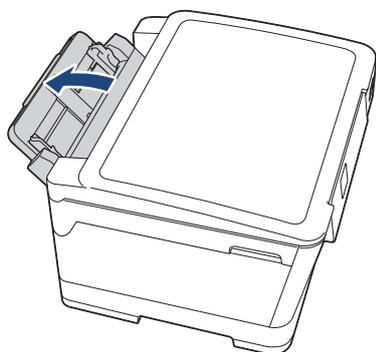
2. Pulse y deslice suavemente las guías del papel de la bandeja MP para que se ajusten al ancho del papel que vaya a utilizar.
