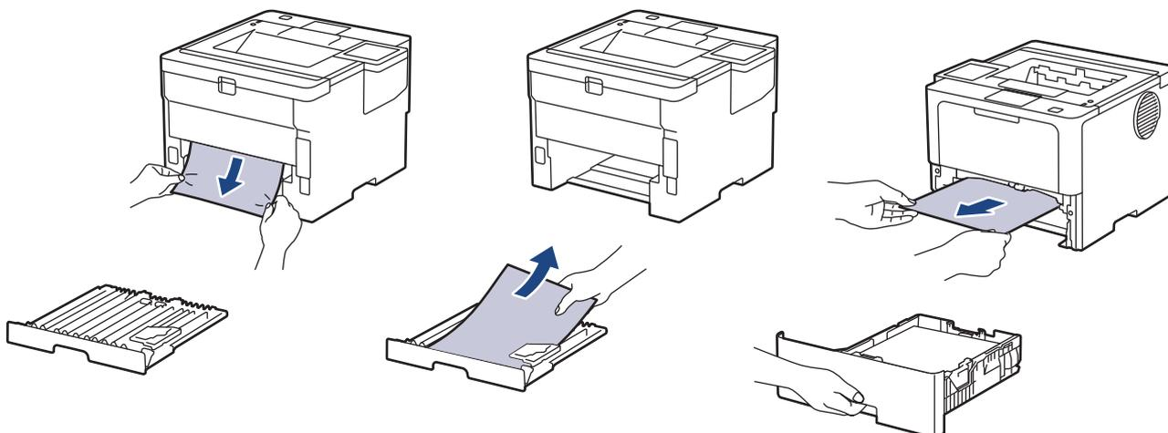
5. Retirez le papier qui pourrait être coincé sous l'appareil en raison de l'électricité statique.
