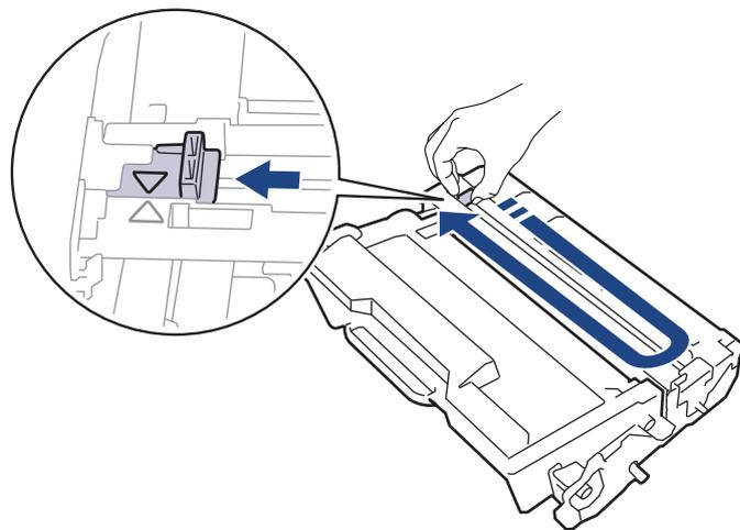
✎ Veillez à ramener la languette à la position d'origine (▲). La flèche sur la languette doit être alignée avec la flèche sur l'unité de tambour. Sinon, les pages imprimées pourraient être marquées d'une bande verticale.
