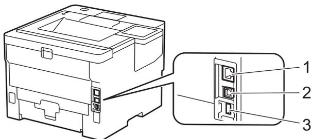
1. Port 10BASE-T / 100BASE-TX / 1000BASE-T (Pour les modèles en réseau)
