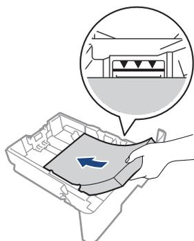
5. Réinstallez le bac à papier fermement dans l'appareil.
