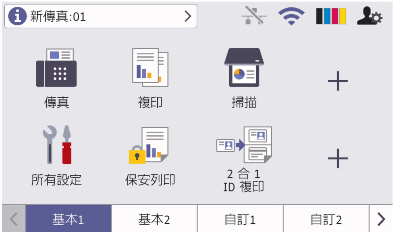
[傳真預覽] 設為 [開] 時，記憶體中已接收的新傳真的數量顯示在螢幕頂部。
