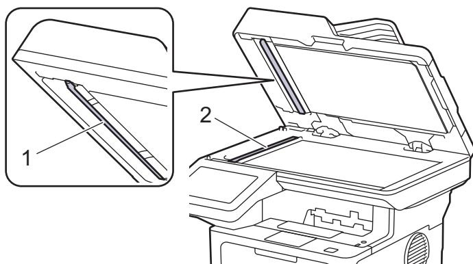
4. (Za modele s automatskim dvostranim skeniranjem) Otvorite poklopac stakla skenera (1), a zatim očistite drugu bijelu traku (2) i prugu stakla skenera (3).
