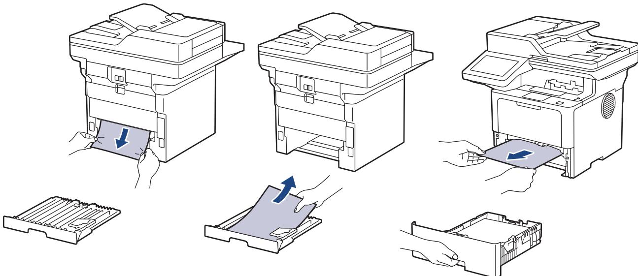
5. Uklonite papir koji se možda zaglavio ispod uređaja zbog statičkog elektriciteta.
