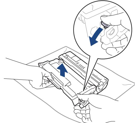
9. Okrenite jedinicu bubnja na način prikazan na ilustraciji. Pazite da se zupčanik jedinice bubnja (1) nalazi na lijevoj strani.
