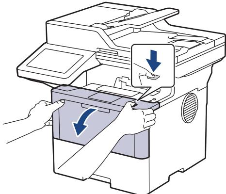
2. Izvadite sklop tonera i jedinice bubenja iz uređaja.
