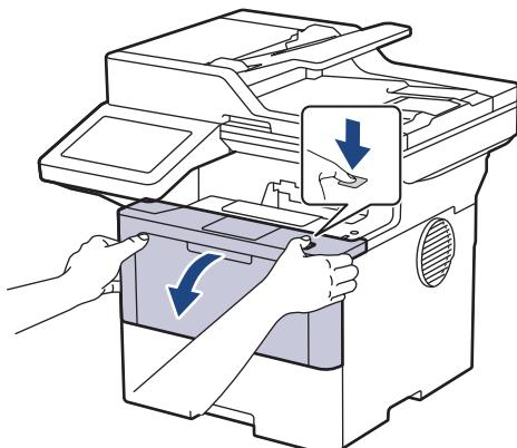
3. Izvadite sklop tonera i jedinice bubnja iz uređaja.
