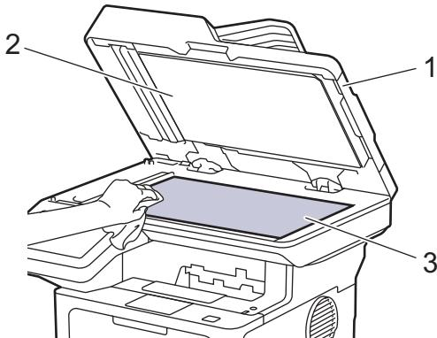
3. U jedinici ADF-a očistite bijelu traku (1) i staklenu prugu skenera (2), koja se nalazi ispod nje, vlažnom mekanom krpom koja ne ostavlja dlačice.
