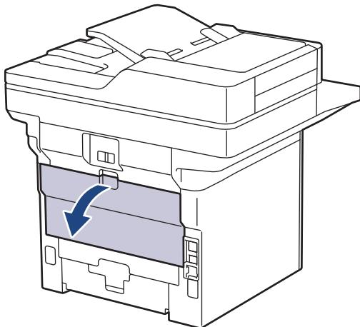
2. Otvorite zaustavljač papira. (MFC-L6910DN/MFC-L6915DN/MFC-EX910)
