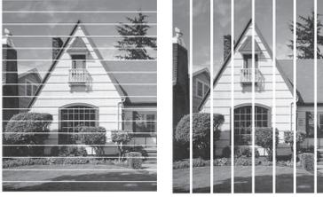
Nach der Reinigung der Druckkopf-Düse sind keine Streifen mehr zu sehen:
