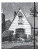
Si hay una mancha de suciedad o restos de corrector líquido en la banda del cristal, la prueba de impresión mostrará una línea vertical.
