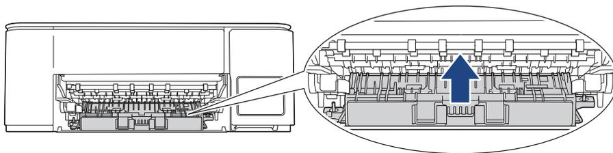
8. Vuelva a colocar el soporte del papel firmemente en el equipo. Asegúrese de que el soporte del papel encaje en los canales.
