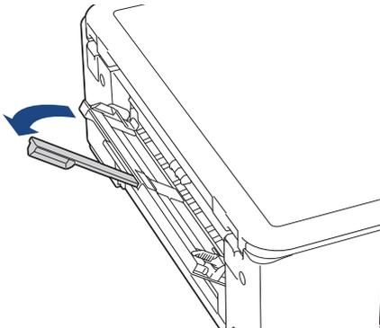
3. Deslice las guías del papel de la ranura de alimentación manual para hacerlas coincidir con el ancho del papel que va a utilizar.
