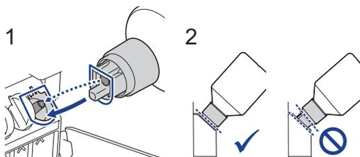
5. La botella se sostendrá firme cuando esté en la posición correcta y la tinta llenará el tanque de forma automática.
