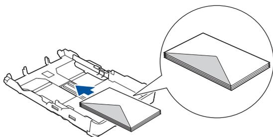
4. Presione ligeramente las guías de anchura del papel (1) y la guía de longitud del papel (2) y deslícelas para adaptarlas al tamaño de los sobres.
