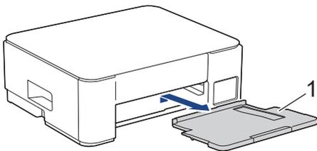
5. Limpie los rodillos de recogida de papel (1) con un paño suave y sin pelusa humedecido en agua. Gire lentamente los rodillos para que se limpie toda la superficie. Seguidamente, pase un paño suave, seco y sin pelusa por los rodillos para eliminar toda la humedad.
