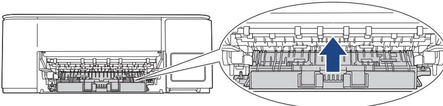
12. Vuelva a colocar el soporte del papel firmemente en el equipo. Asegúrese de que el soporte del papel encaje en los canales.
