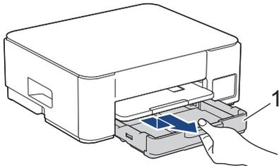
4. Levante el soporte del papel (1) y, a continuación, tire en ángulo hasta extraerlo por completo del equipo tal y como indica la flecha.
