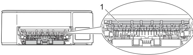
8. Empuje hacia abajo la protección para el desatasco de papel (1) en la parte trasera del equipo y luego ábrala (2).
