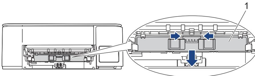
6. Limpie los rodillos de alimentación del papel (1) realizando un movimiento lateral con un paño suave y sin pelusa humedecido en agua. Seguidamente, pase un paño suave, seco y sin pelusa por los rodillos para eliminar toda la humedad.
