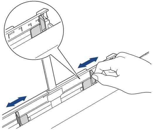
4. لا تتم بتحميل سوى ورقة واحدة فقط في فتحة التغذية اليدوية بحيث يكون سطح الطباعة متجهًا لأعلى. استخدم كلتا يديك، اضغط موجهات الورق في فتحة التغذية اليدوية للتأكد من عدم وجود فجوة بينها وبين الورق.
