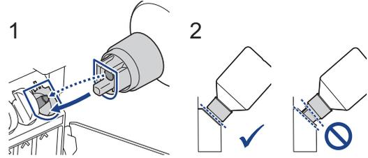
5. تستند القارورة في موضعها تلقائيًا عندما تكون في الوضع الصحيح ويتم تعبئة الحبر في الخزان تلقائيًا. إذا لم يبدأ تدفق الحبر تلقائيًا أو إذا كانت تعبئة الحبر في الخزان بطيئة جدًا، قم بعناية بنزع القارورة وإعادة إدخالها.
