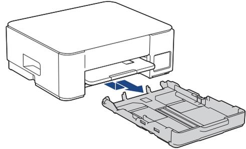
3. اضغط على زر تمديد درج الورق المربع (1) واسحب درج الورق حتى يستقر زر تمديد الورق المربع في فتحة LGL المربعة.
