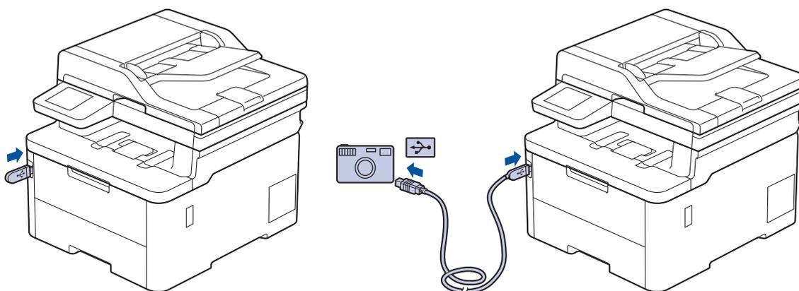
1. Connectez votre clé USB ou appareil photo numérique à l'interface USB directe. L'écran tactile affiche automatiquement le menu de la mémoire USB pour confirmer que la clé USB ou l'appareil photo numérique est connecté correctement.
