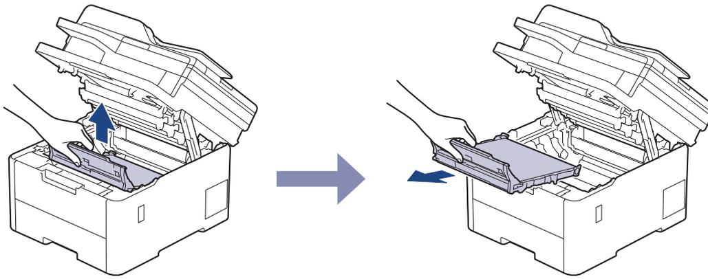
5. Déballez la nouvelle unité de courroie et insérez-la dans l'appareil.
