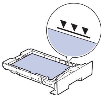
5. Remettez fermement le bac à papier dans l'appareil.
