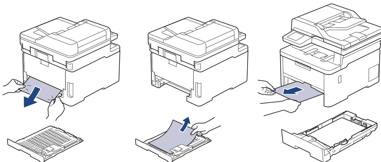
5. Retirez le papier qui pourrait être coincé sous l'appareil en raison de l'électricité statique.
