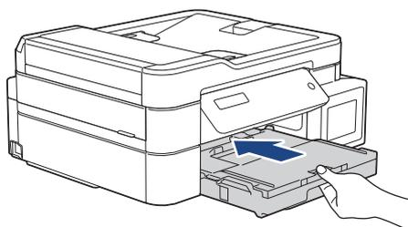
14. Mientras mantiene sujeta la bandeja de papel en el equipo, tire del soporte del papel (1) hasta que quede inmobilizado en posición correcta y, a continuación, despliegue la lengüeta del soporte del papel (2).
