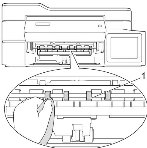
5. (MFC-T910DW) Levante la lengüeta para el desatasco de papel (2) y, a continuación, limpie la parte posterior de los rodillos de alimentación del papel (1) con un paño suave y sin pelusa humedecido en agua. Seguidamente, pase un paño suave, seco y sin pelusa por los rodillos para eliminar toda la humedad.
