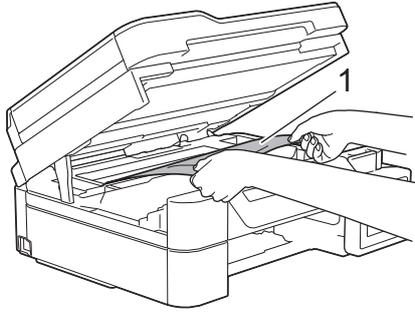
6. Mueva el cabezal de impresión (si es necesario) para retirar todo el papel que quede en esta zona. Asegúrese de que no queden trozos de papel en las esquinas del equipo (1) y (2).
