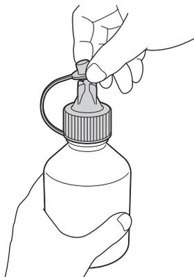
5. Compruebe que el color del tapón del tanque de tinta coincide con el color de la tinta que desea rellenar. Introduzca la boquilla de la botella de tinta firmemente de forma que no se salga la tinta. Rellene el tanque de tinta apretando suavemente la botella de la forma mostrada en la ilustración.
