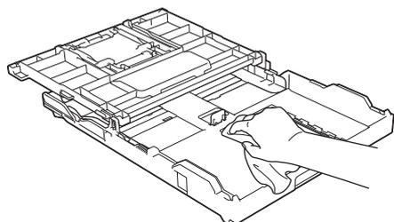
6. Cierre la cubierta de la bandeja de salida del papel y vuelva a introducir lentamente la bandeja de papel en el equipo.
