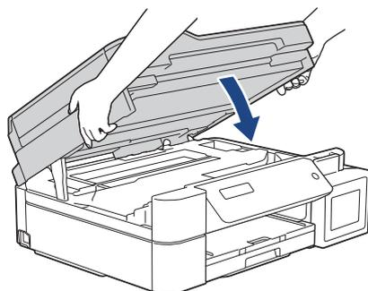
6. Abra la cubierta de los tanques de tinta.
