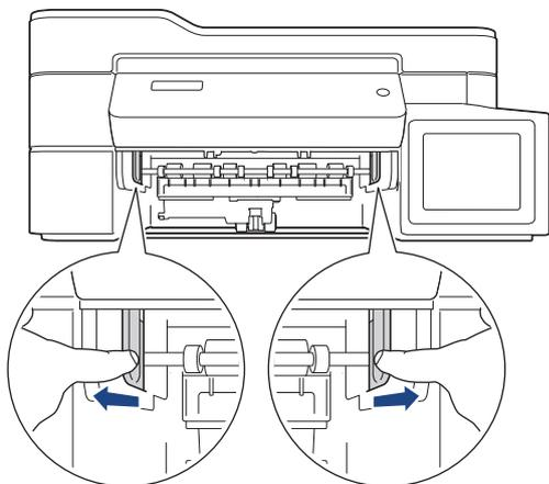
4. Coloque las manos debajo de las lengüetas de plástico ubicadas a ambos lados del equipo para levantar la cubierta del escáner (1) hasta su posición de apertura.
