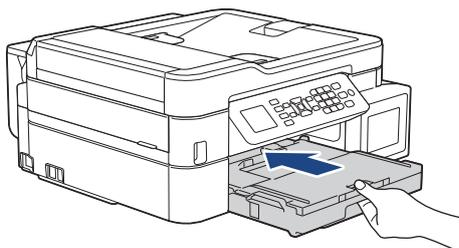
8. Mientras mantiene sujeta la bandeja de papel en el equipo, tire del soporte del papel (1) hasta que quede inmobilizado en posición correcta y, a continuación, despliegue la lengüeta del soporte del papel (2).
