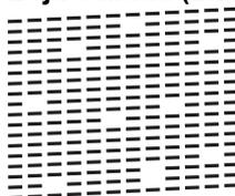
6. En la pantalla LCD se le pedirá que compruebe la calidad de impresión de cada color. Pulse **▲** o **▼** para seleccionar uno de los patrones que más se asemeje al resultado de la impresión y, a continuación, pulse **OK**.
