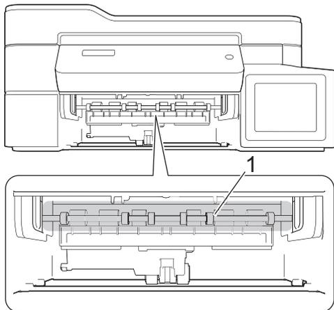
10. Apriete ambas palancas (1) y, a continuación, abra la cubierta para el desatasco de papel situada en la parte posterior del equipo.
