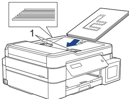
4. Coloque el documento **cara abajo** e introduciendo el **borde superior en primer lugar** en la unidad ADF y debajo de las guías del papel, y espere hasta que note que el documento toca los rodillos de alimentación y en la pantalla LCD aparece [ADF listo].
