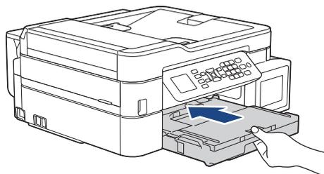
11. Mientras mantiene sujeta la bandeja de papel en el equipo, tire del soporte del papel (1) hasta que quede inmobilizado en posición correcta y, a continuación, despliegue la lengüeta del soporte del papel (2).
