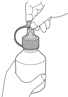
5. Certifique-se de que a cor da tampa do tanque de tinta corresponde à cor da tinta que deseja reabastecer. Insira o bocal do frasco de tinta com firmeza para não derramar a tinta. Reabasteça o tanque de tinta apertando o frasco delicadamente conforme mostrado na ilustração.
