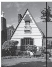
Quando há uma mancha de sujidade ou de líquido corretor no vidro, a amostra digitalizada apresenta uma linha vertical.
