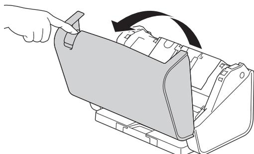
3. Appuyez sur le côté supérieur gauche du capot du rouleau d'entraînement vers le bas et tirez-le vers le bas.
