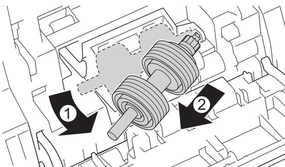
12. Installez le nouvel arbre du rouleau de frein dans l'ouverture, comme indiqué, et insérez le rouleau de frein dans l'appareil.
