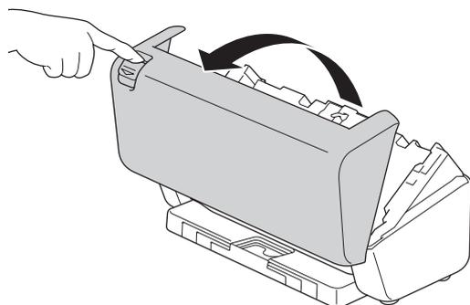
3. Appuyez sur le côté droit du capot du rouleau d'entraînement vers la gauche et le tirer vers le bas.
