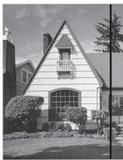
Se houver alguma sujeira ou fluido de correção na faixa de vidro, uma linha vertical aparecerá na amostra digitalizada.
