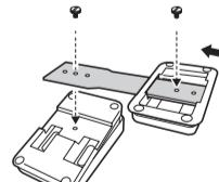
Alignez le bord large de la plaque d'assemblage sur l'encoche en dessous de la pédale principale, puis fixez-les ensemble à l'aide d'une vis. Introduisez l'autre côté de la plaque d'assemblage dans l'encoche en dessous de la pédale latérale, puis fixez-les ensemble à l'aide d'une vis.
