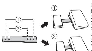
L'espacement de la pédale peut être réglé en fonction des trous de vis utilisés dans la plaque d'assemblage. L'espacement des pédales est au maximum si vous utilisez les trous de vis les plus éloignés pour les fixer (1). Il est au minimum si vous utilisez les trous de vis les plus proches pour les fixer (2).
