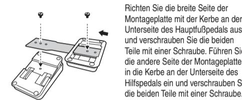
Richten Sie die breite Seite der Montageplatte mit der Kerbe an der Unterseite des Hauptfußpedals aus und verschrauben Sie die beiden Teile mit einer Schraube. Führen Sie die andere Seite der Montageplatte in die Kerbe an der Unterseite des Hilfspedals ein und verschrauben Sie die beiden Teile mit einer Schraube.
