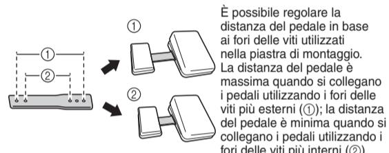
È possibile regolare la distanza del pedale in base ai fori delle viti utilizzati nella piastra di montaggio. La distanza del pedale è massima quando ci collegano i pedali utilizzando i fori delle viti più esterni (①); la distanza del pedale è minima quando ci collegano i pedali utilizzando i fori delle viti più interni (②).
