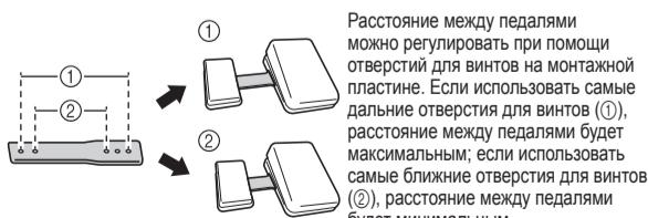
Расстояние между педалями можно регулировать при помощи отверстий для винтов на монтажной пластине. Если использовать самые дальние отверстия для винтов (①), расстояние между педалями будет максимальным; если использовать самые близкие отверстия для винтов (②), расстояние между педалями будет минимальным.
