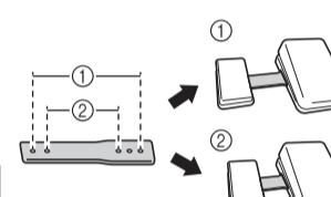
Der Pedalabstand kann mithilfe der Schraubenbohrungen in der Montageplatte eingestellt werden. Der Pedalabstand ist am größten, wenn die Pedale an den äußersten Schraubenbohrungen (1) befestigt werden. Der Pedalabstand ist am kleinsten, wenn die Pedale an den innersten Schraubenbohrungen (2) befestigt werden.
