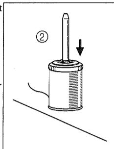
② Placer la bobine sur la tige et insérer dessus le capuchon de bobine en serrant bien la bobine. (Ne pas coincer le fils sous la bobine.) .
