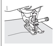
模様ぬい押え <N>と同じ用途で使用できます。N押えを使用する模様をぬう時に向いています。
