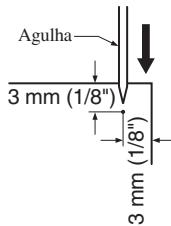
1. Posicione o tecido (lado avesso virado para cima) sob o calcedor. Desça a agulha a 3 mm (1/8") das bordas do tecido, abaixe o calcedor e, em seguida, costure dois ou três pontos.
