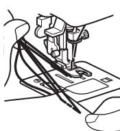
3. Segurando ambas as linhas, passe-as através da parte curva do calcedor e puxe-as em direção à parte de trás do calcedor. Enrole o tecido na parte curva do calcedor da mesma forma. Posicione a ponta do tecido logo atrás da agulha e abaixe o calcedor.
