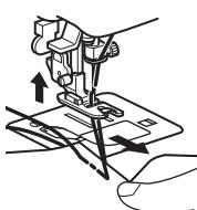
2. Levante a agulha e o calcedor. Em seguida, segure as extremidades das linhas superior e inferior para impedi-las de serem puxadas para fora do tecido e puxe o tecido para a frente do calcedor.
