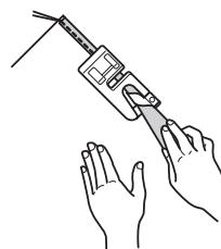
5. Depois de costurar 2 cm (3/4") a 3 cm (1-1/8") do tecido, solte a linha e guie o tecido a partir da frente do calcedor usando a mão esquerda. Mantenha uma quantidade uniforme de tecido enrolada em torno da parte curva do calcedor até que a costura seja completada.
