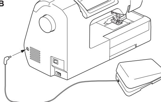
マルチ機能フットコントローラーを使用すると、縫製のスタート／ストップのほかに糸切りや返し縫いなど、さまざまな機能を設定してミシンを操作することができます。
