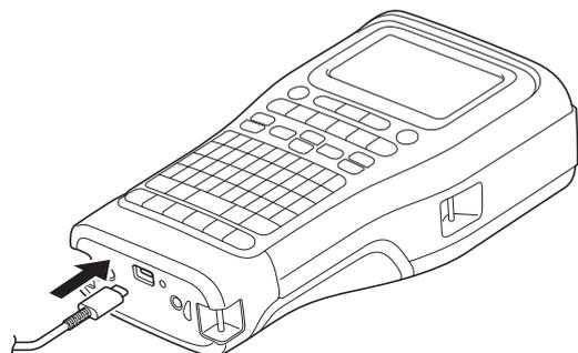
Cuando la batería está completamente cargada, el LED se apaga.
