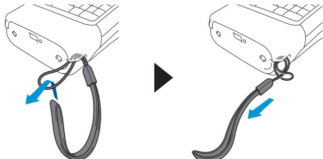
Ove upute opisuju kako pričvrstiti potporni remen na desnu stranu pisača za naljepnice tako da ga možete držati desnom rukom. Također možete pričvrstiti potporni remen na lijevu stranu pisača za naljepnice i držati ga lijevom rukom.
