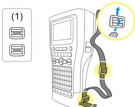
4. Faites passer la sangle de support par le trou situé sur le côté du système d'étiquetage, comme indiqué.
