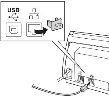
**c** 将接口电缆连接到网络。
