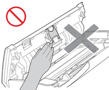
请勿握住顶盖来移动设备，否则设备可能会从您的手中滑落。搬运设备时，请务必用双手抓住设备底部。
